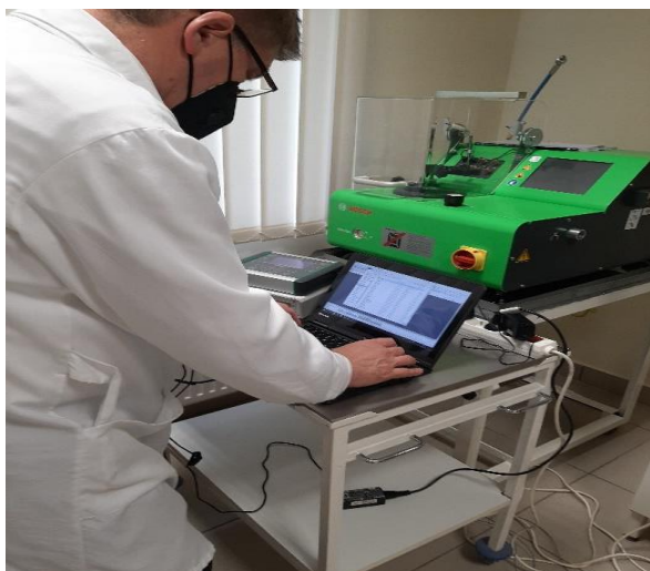
Rejestracja sygnału akustycznego w strudze wtryskiwanego paliwa
