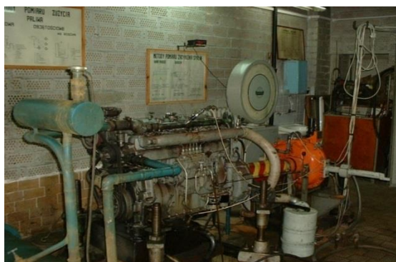
Stanowiska hamowniane do badań silników ze wstępną obróbką paliwa
