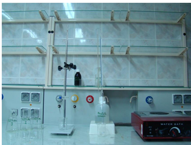
Rys. 1. Stanowisko laboratoryjne do oznaczania utlenialności
