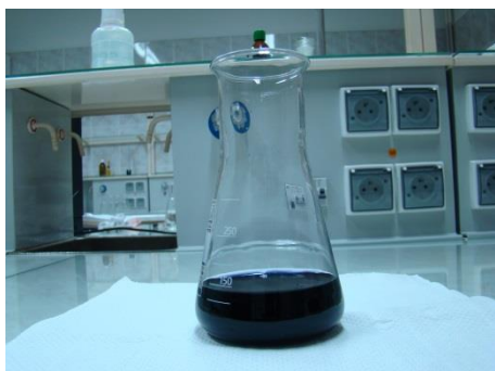
Rys. 8. Próbkę po dodaniu roztworu skrobi
