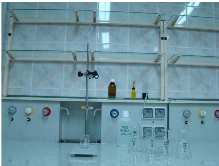
Rys. 2. Stanowisko laboratoryjne do oznaczania jonów chlorkowych metodą Mohra
