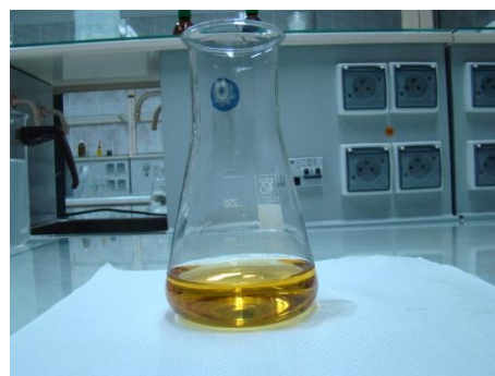
Rys. 6. Przygotowana próbka do miareczkowania
