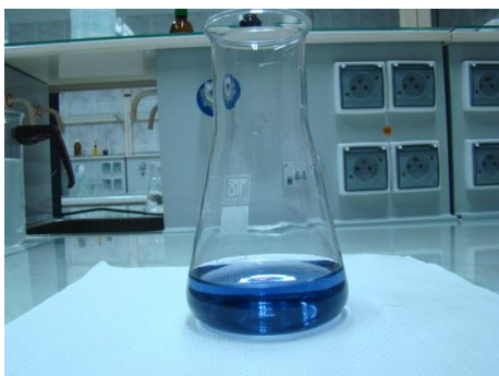
Rys. 9. Próbką w trakcie miareczkowania tuż przed odbarwieniem
