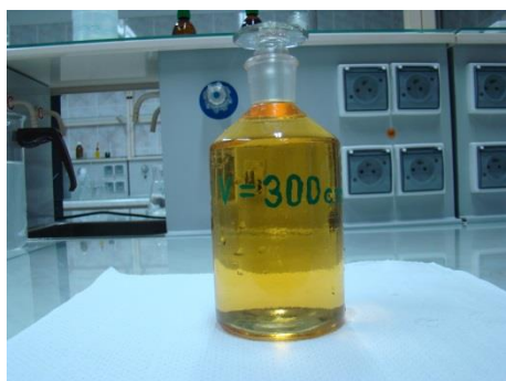
Rys. 5. Próbkę po dodaniu kwasu siarkowego
