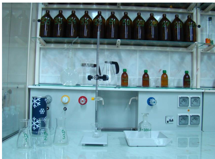
Rys. 2. Stanowisko laboratoryjne do oznaczania tlenu w wodzie metodą Winklera
