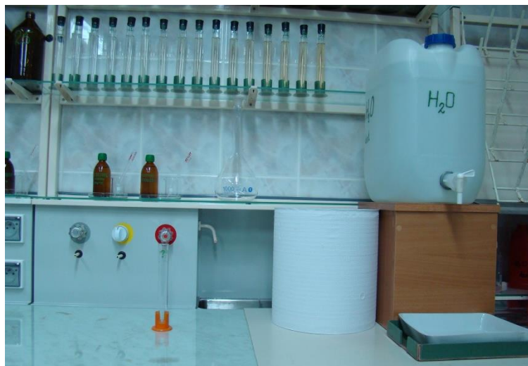
Rys. 11. Stanowisko laboratoryjne do oznaczania azotu amonowego
