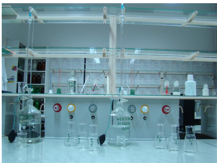
Rys. 1. Stanowisko laboratoryjne do oznaczania twardości ogólnej i twardości wapniowej
