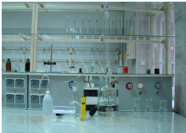
Rys. 3. Stanowisko laboratoryjne do oznaczania pH oraz zasadowości p i m wody
