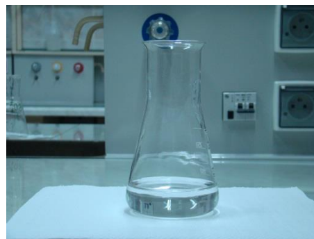
Rys. 5. Końcowy efekt miareczkowania (oznaczanie alkaliczności p )
