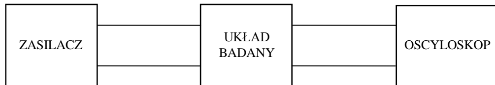
Rys. 7.3.1. Układ pomiarowy do badania generatorów
